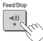
按 Feed/Stop 按鍵書寫面將向左滾動一個板面並自動停止。要中途停止操作，再按 Feed/Stop 按鍵。
